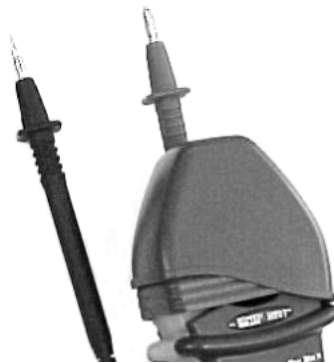
Fig. 3: Utilisation du capuchon en caoutchouc du câble de test
